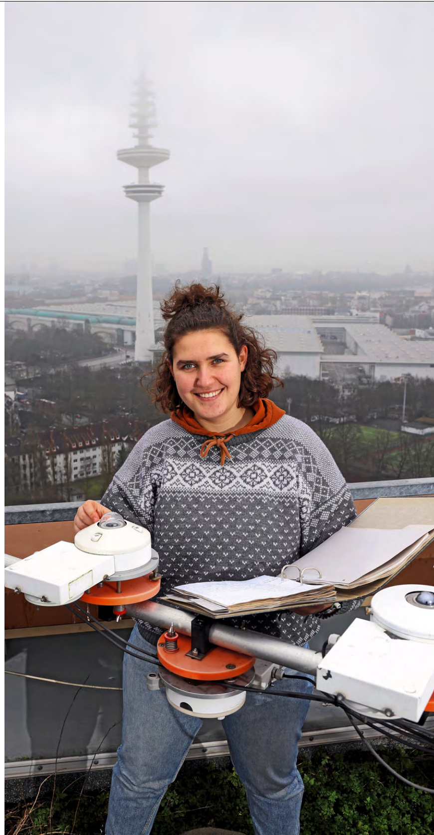
Die angehende Meteorologin Katharina Stolla kontrolliert auf dem Dach vom Geomatikum ein Instrument zur Strahlungsmessung. FOTO: STEPHAN WALLOCHA
